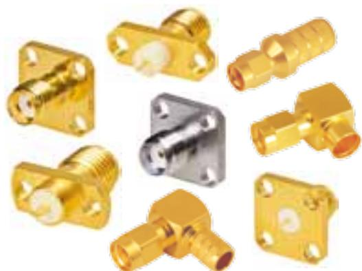
Серия SMA - это очень популярные миниатюрные коаксиальные соединители с резьбовым соединением. Соединители разработаны и производятся согласно стандартам MIL -C- 39012, IEC169-15 и CECC22110. Соединители имеют очень высокую надежность, низкий и стабильный КСВН во всем диапазоне частот (до 18ГГц). Широко применяются в любых системах радиосвязи.
